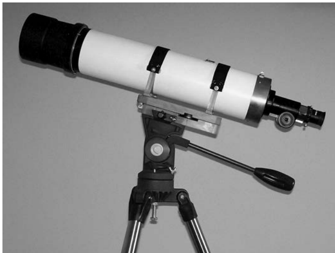
Самодельный 100-мм рефрактор с объективом от трубы Юкон 6-100×100 на азимутальной монтировке от телескопов серии "Celestron AstroMaster".
