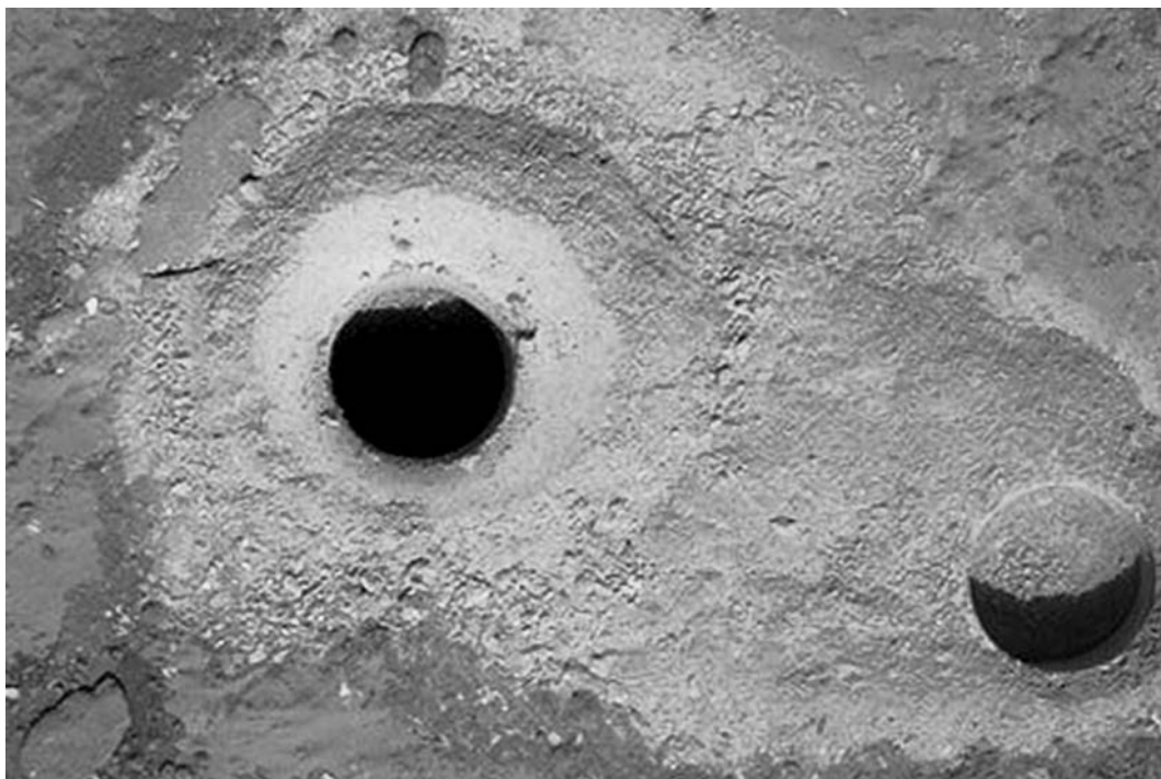
Отверстие, пробуренное «Кьюриосити» на поверхности Марса. 9 февраля 2013 г. Фото NASA/JPL.
